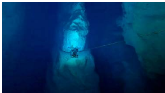
水深約 340m の深海洞窟に挑む 洞窟探査用の小型 ROV
